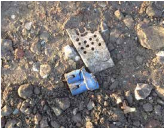
Met dit zogeheten menggranulaat worden in Brabant zandpaden verhard. Foto: Brabantse Milieufederatie.
